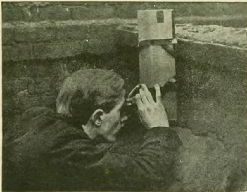
Bardzo łatwy do zbudowania periskop, który może oddać wielkie usługi w rowach strzeleckich a składa się jedynie za zwyczajnej lornetki polowej, dwóch luster oraz skrzynki drewnianej.
