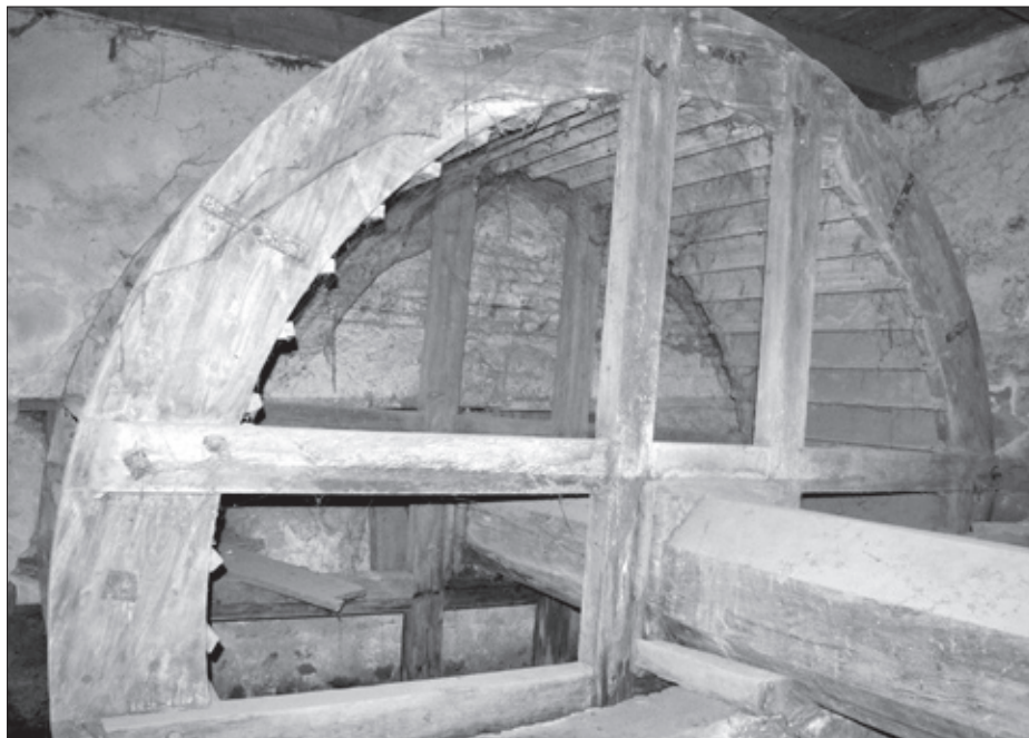
Koło młyńskie śródsiebierne o średnicy 4 m z młyna Antoniego Kacza w Cyganowicach, stan 2019 r. Fot. B. Potoniec
